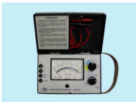
Переносный показывающий со стрелочным указателем прибор. Предназначен для измерения напряжения и силы постоянного и переменного токов, сопротивления постоянному току.
